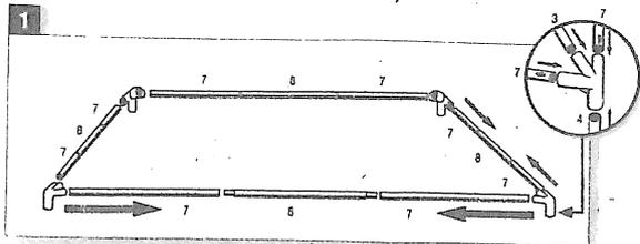
Als erstes setzen Sie die Dachkonstruktion zusammen. Benutzen Sie dazu zunächst die Kunststoffeckverbindungen sowie die Metallrohre Nr. 7 und Nr. 8. (Reihenfolge siehe Abbildung 1)
