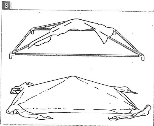
Ziehen Sie die Dachfolie über die Dachkonstruktion und über die Eckverbindungen.
