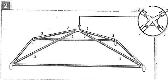
Nun verbinden Sie die Rohre für das Dach (siehe Abbildung Nr. 2) in der Reihenfolge Nr. 2 und Nr. 3 und stecken diese in das Kunststoffskelett und dann in die Eckverbindung.
