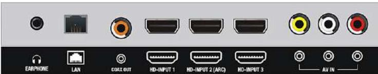
Verwenden Sie zur Herstellung der grundlegenden Verbindungen das Audio-L/R- (weiß/rot) und das CVBS-Kabel (gelb), um das Gerät mit anderen Geräten zu verbinden.
