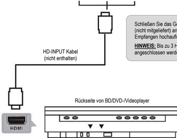
Schließen Sie das Gerät über ein HD-INPUT Kabel (nicht mitgeliefert) an anderen Geräten zum Empfangen hochauflösender Multimedia-Signale an.
