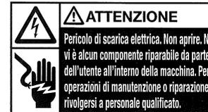
Questo messaggio di sicurezza significa che potreste rimanere feriti gravemente o uccisi se aprite la macchina con conseguente esposizione accidentale ad alto voltaggio.
