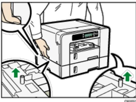
Greifen Sie in die Aussparungen an der Basis des Geräts. Heben Sie die Einheit langsam an und überanstrengen Sie sich nicht.
