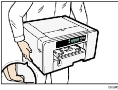
Greifen Sie wie gezeigt in die Aussparungen an der Basis des Geräts. Heben Sie das Gerät hoch und tragen Sie es langsam und vorsichtig.
